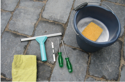
Schritt 1 Folgendes bereitlegen: Eimer mit Seifenwasser, Schwamm, Schraubenzieher, Cutter, Abzieher, trockenes, sauberes Tuch.
