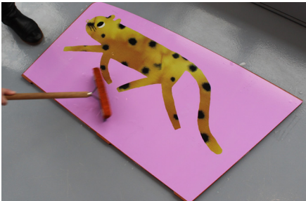
Schritt 7 Auf dem nassen Untergrund lässt sich die Position noch leicht korrigieren. Dann den Transportbox-Aufkleber mit dem Abzieher glattstreichen und dabei Luft und Wasser ausdrücken.
